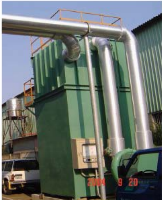
■ 卡盤式集塵機應用於PCB產業
